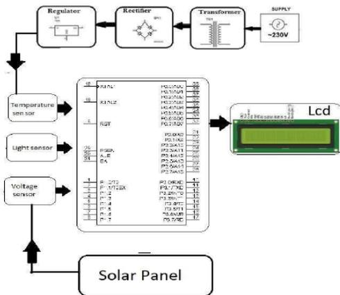
FIG.2.1. BLOCK DIAGRAM
