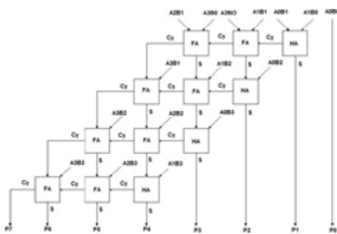
Fig. 3. 4 X 4 Array Multiplier
