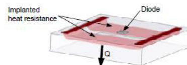
Fig. 4: Thermal test die structure
